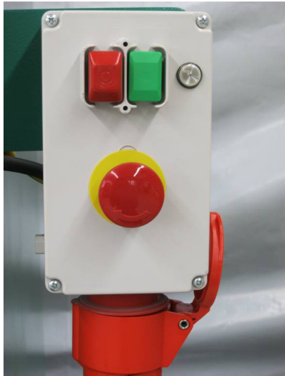
Hauptschalter mit Not-Aus
